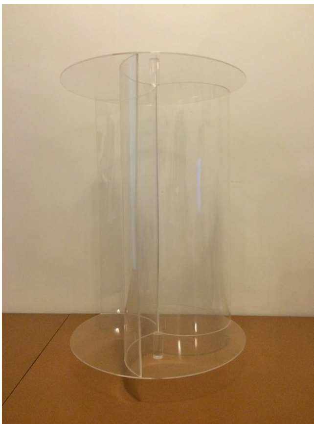
Figura 9.1 – Foto do rotor projetado em acrílico.
